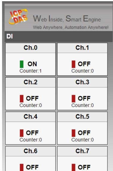
圖 9-4：手機版 I/O 通道資訊顯示頁面
