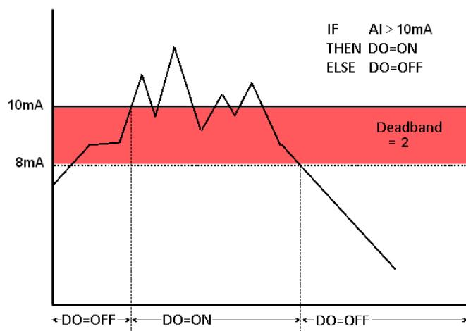
圖 5-4：AI Deadband 示意圖(作用於大於條件)
