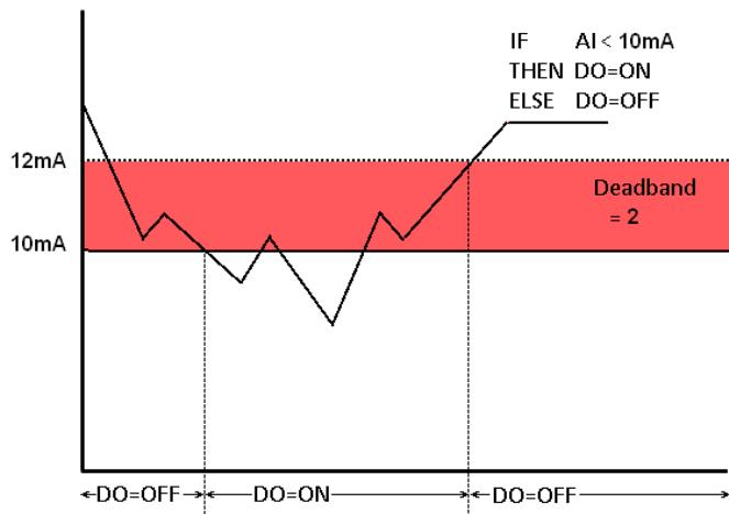
圖 5-5 : AI Deadband 示意圖(作用於小於條件)
