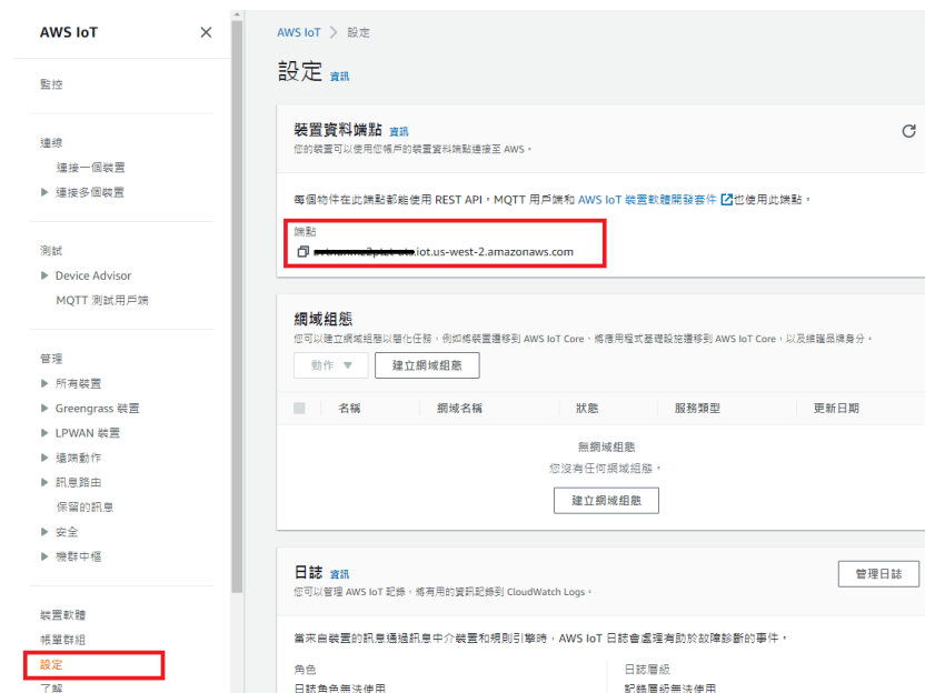
图 8-2: Amazon Web Services 装置端点数据显示页面
