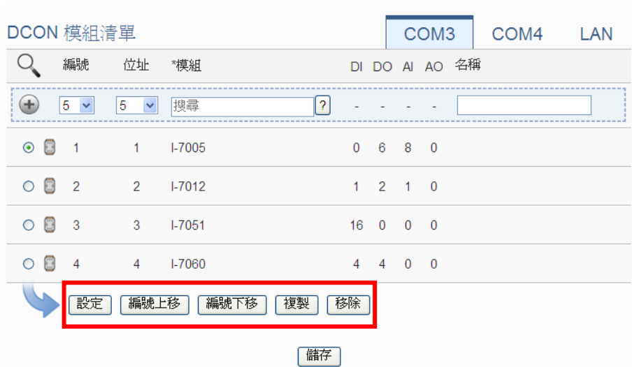
图 6-16: I-7000/DL DCON 模块列表操作页面
