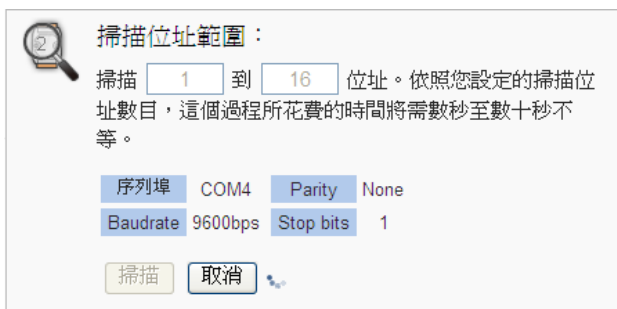
图 6-24: 泓格内建 Modbus RTU 模块扫描进行中
