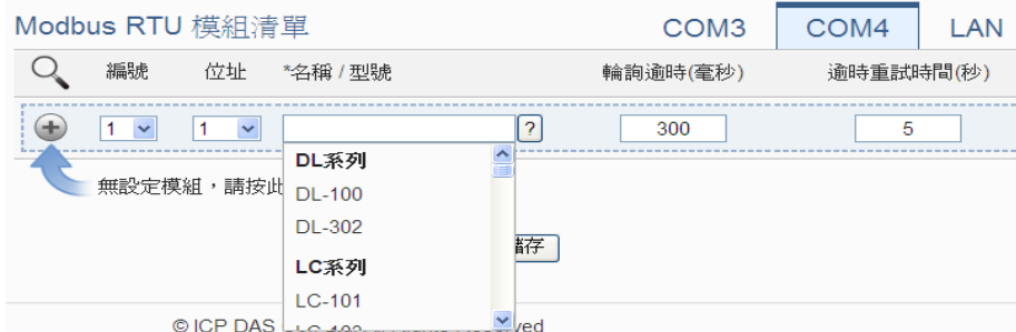
圖 6-28：Modbus RTU 模組名稱/型號設定
