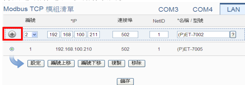
图 6-45: 新增 Modbus TCP 模块按钮
