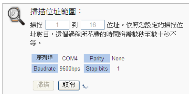
图 6-24: 泓格内建 Modbus RTU 模块扫描进行中
