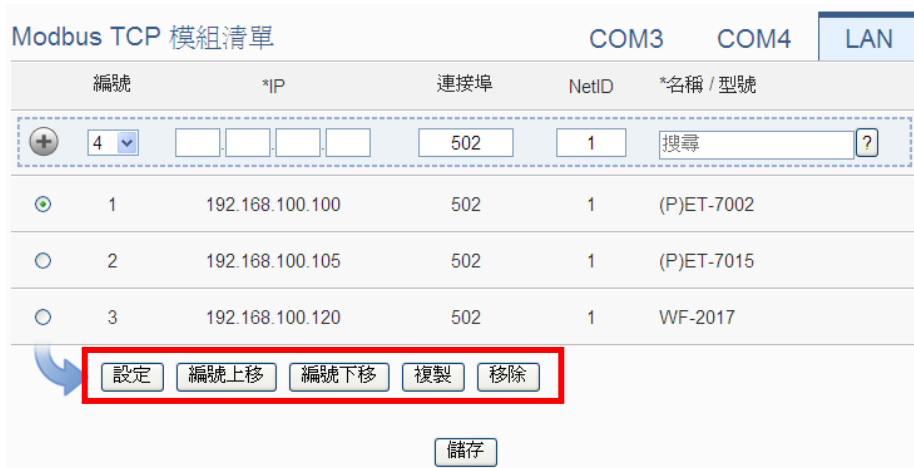
图 6-46: Modbus TCP 模块列表操作页面
