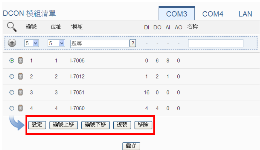
圖 6-16：I-7000/DL DCON 模組清單操作頁面
