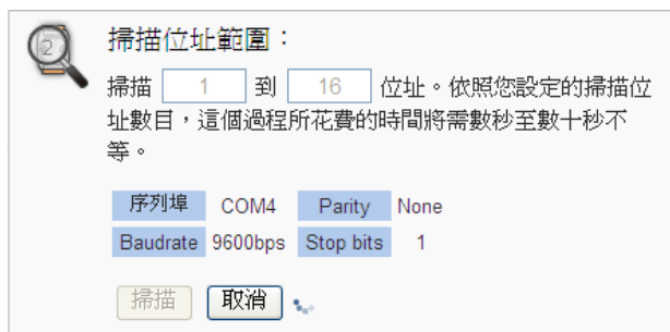
圖 6-24：泓格內建 Modbus RTU 模組掃描進行中
